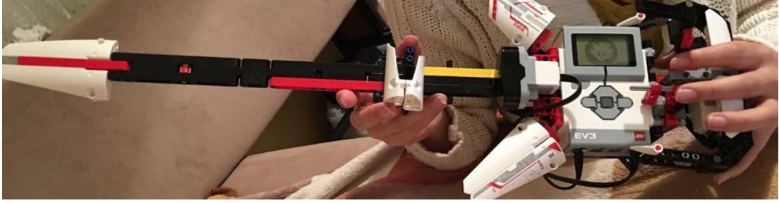
Şekil 2. Lego Mindstorm EV3 ile oluşturulan Gitar Uygulaması
