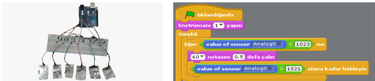
Şekil 6. Arduino ve Scratch ile Piyano Projesi ve örnek kod blokları
